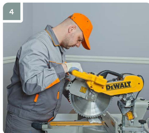
4 Выставить угол на торцовочной пиле, произвести запил изделия. В помещениях с углами, равными 90°, возможно использование стусла и ножовки.
